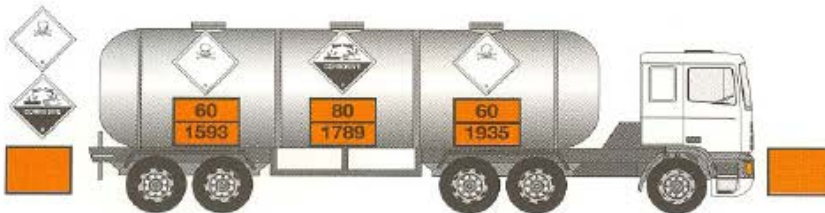
Trasporto di merci pericolose in cisterna compartimentata
